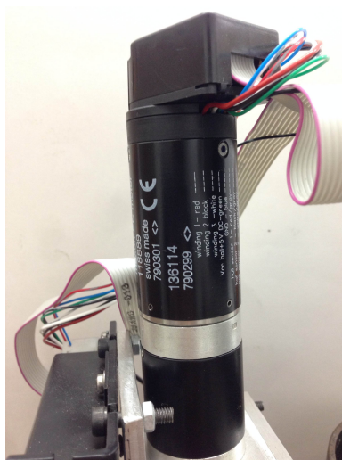
Figura 6: Motor Maxon EC 32, sem escovas - 80 Watt.
