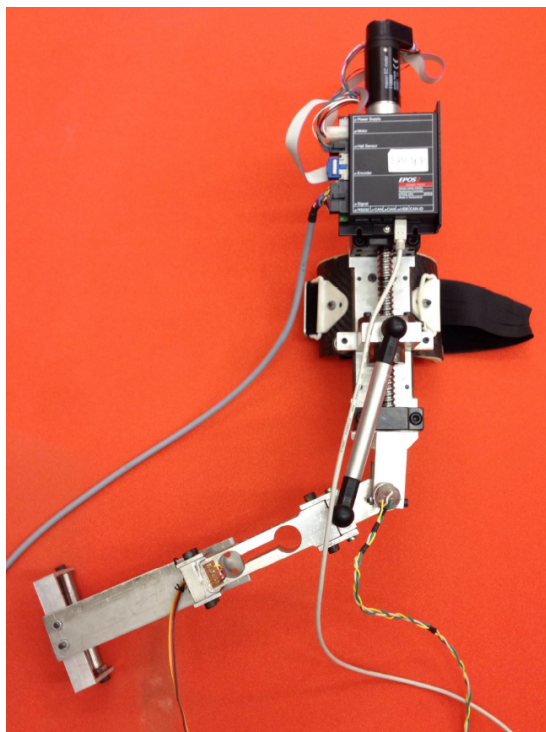
Figura 2: Estrutura do exoesqueleto de membro superior, vista 2.
